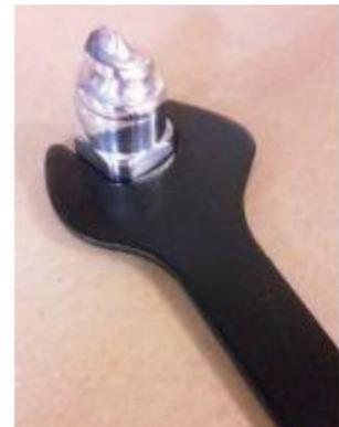
Bei CARUS: Die Oberkante der Aufnahme der Scheibe schließt fast bündig ab mit der Oberkante der Aufnahmeachse.
